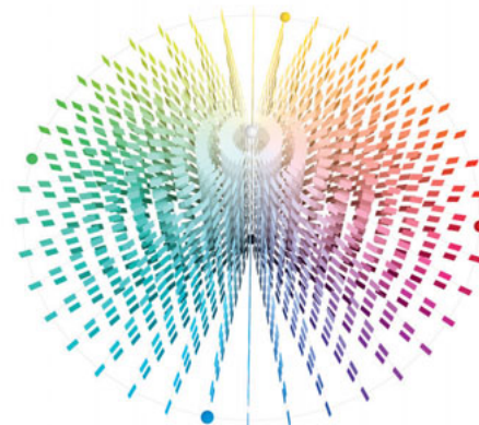
Das NCS-Farbsystem lässt sich in Form eines Doppelkegels darstellen, bei dem die vertikale Schwarz-Weiss-Achse die beiden Kegelspitzen verbindet und die «reinen» Bunttöne die Basis der beiden Kegel bilden.
