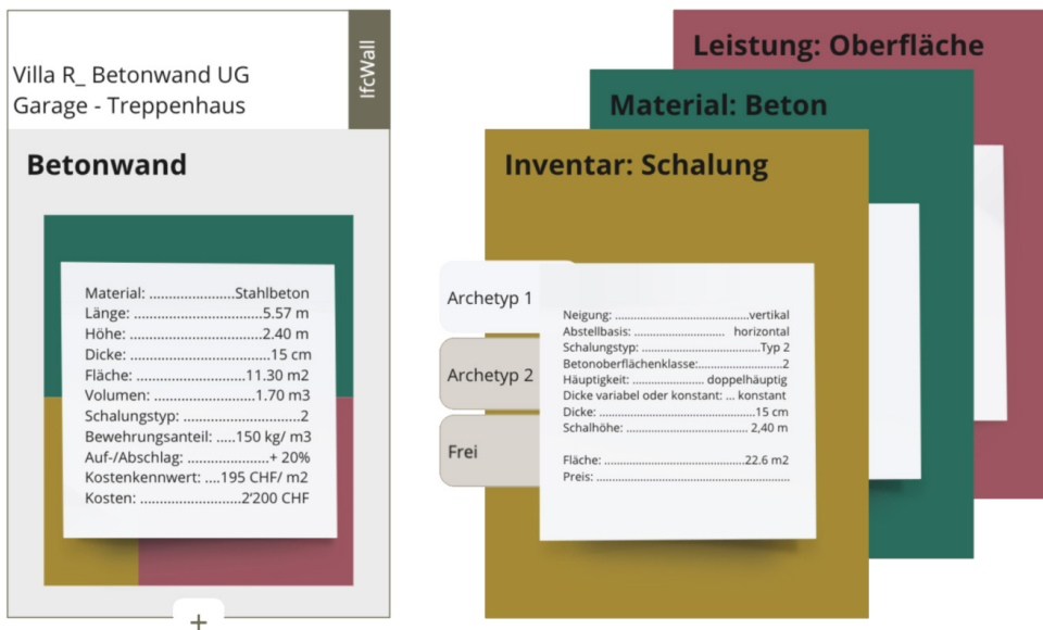
Abbildung 3: Beispiel Komposit Betonwand
